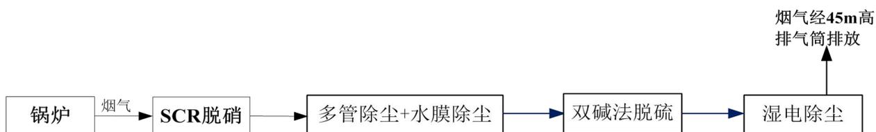
图4.1-3 锅炉烟气污染控制流程
